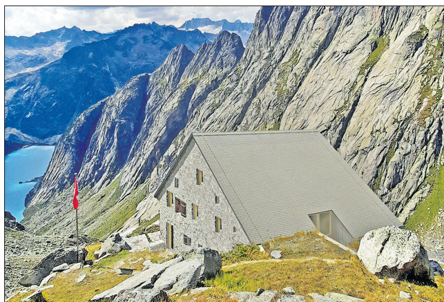
Die Visualisierung der neuen Gelmerhütte zeigt: Das Dach ist im Fels verankert und dient gleichzeitig als Lawinenschutz.
