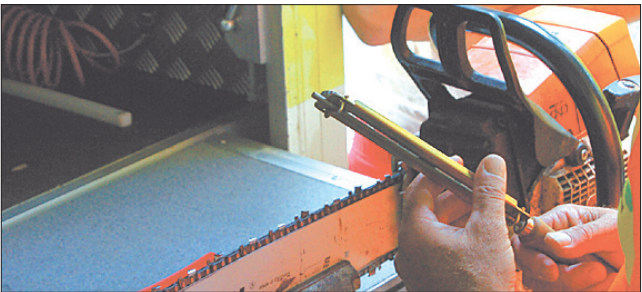
Oben ist ein Instruktor mit dem Freischneider im Einsatz, unten demonstriert ein Lehrer das richtige Schränken eines Kettensägeblatts.
