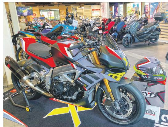
Exklusiver Blickfang: Bei der Aprilia Tuono X zeugen vorne die grossen Carbon Winglets vom MotoGP-Anspruch – sie erhöhen die Stabilität im Toppspeed-Bereich sowie in den entscheidenden Phasen bei extremem Bremsen und Beschleunigen.
