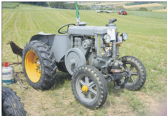
Links der Landini-Traktor aus dem Jahre 1948. Der Typ «Velite» wiegt 2000 Kilo und leistet 45 PS. Rechts eine Rarität: Der Dreirad-Traktor des Typs «Lokomotive» der Schweizerischen Lokomotiv- und Maschinenfabrik Winterthur SLM aus dem Jahre 1937. Motorenbauerin war die als Töff-Produzentin bekannte Motosacoche, die vor dem 2. Weltkrieg als grösster Einbaumotoren-Herstellerin Europas galt.
