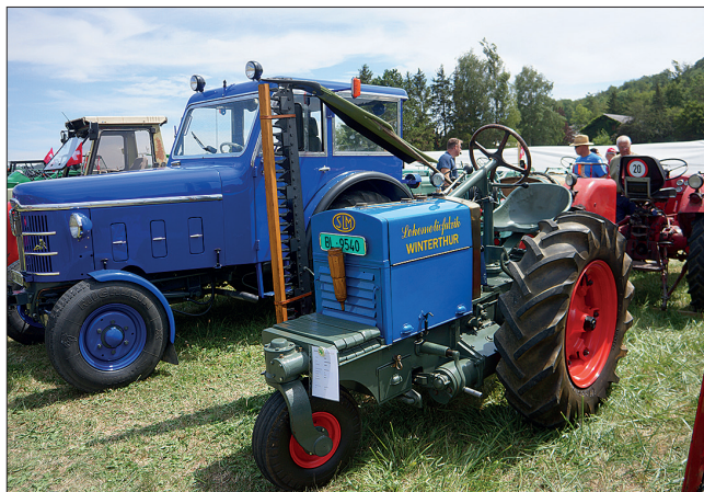
Links der Landini-Traktor aus dem Jahre 1948. Der Typ «Velite» wiegt 2000 Kilo und leistet 45 PS. Rechts eine Rarität: Der Dreirad-Traktor des Typs «Lokomotive» der Schweizerischen Lokomotiv- und Maschinenfabrik Winterthur SLM aus dem Jahre 1937. Motorenbauerin war die als Töff-Produzentin bekannte Motosacoche, die vor dem 2. Weltkrieg als grösster Einbaumotoren-Herstellerin Europas galt.
