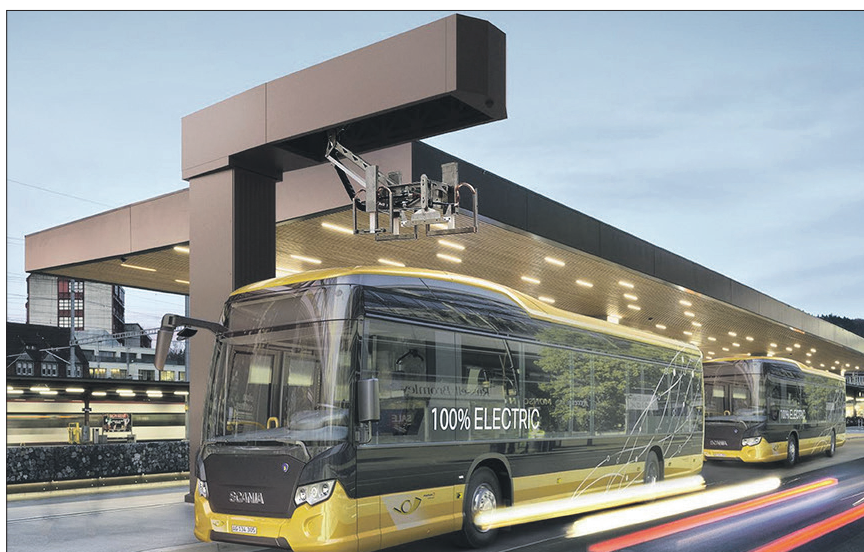
So soll die Ladestation für das Elektropostauto – mit dem Pantographen – am Busbahnhof aussehen. (Visualisierung: Walker Architekten AG/swissinteractive AG)
