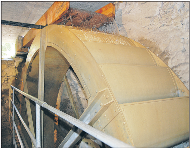
Das überschlächtige Mühlrad setzt über das Getriebe (rechts) den darüber liegenden Läufer in Bewegung. Dieser rotiert auf dem Bodenstein.
