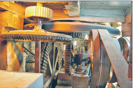
Das überschlächtige Mühlrad setzt über das Getriebe (rechts) den darüber liegenden Läufer in Bewegung. Dieser rotiert auf dem Bodenstein.
