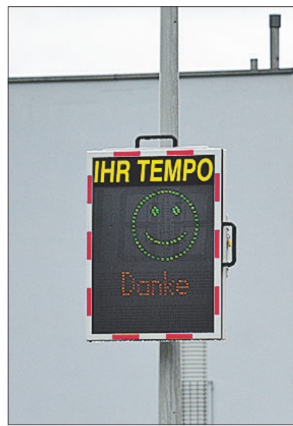
Momentan hängt der «Speedy» an der Langmattstrasse vor den Schulanlagen. Er zeigt den korrekt fahrenden einen grünen Smiley, den zu schnellen einen grimmig-roten. Das Gerät wird demnächst an der ebenfalls als neuralgischer Schüler-Übergang geltenden Laurstrasse installiert.
