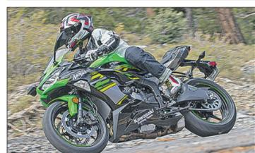
Das scharfe Styling der neuen Kawasaki Ninja ZX-6R mit LED-Doppelscheinwerfer an der Front und das kantige Heck kennzeichnet das Ninja Design für 2019. Der legendäre 636cc Motor dient der neuesten Ninja als Basis, ist mit Quickshifter und KTRC-Traktionskontrolle sowie einem neuen Cockpit ausgestattet und bietet so eine gute Balance zwischen Strassen- und Rennstrecken-Nutzung.
