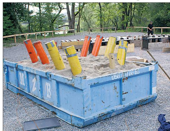
«Einzelrohre für Einzelschüsse werden zur Sicherung in eine mit Sand gefüllte Mulde vergraben und ebenfalls verbunden», erklärt Peter Roth.
