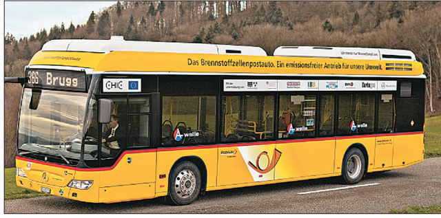
Eines der in der Region verkehrenden Postautos mit Wasserstoff-Antrieb. Unten rechts die einzige H 2 -Tankstelle der Schweiz im Wildschachen und die Regional-Ausriss.
