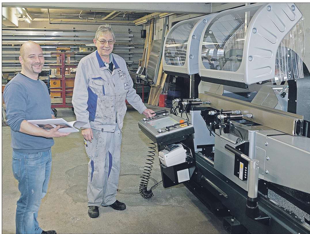
«Ihr Metallbauer aus der Region», so der Slogan des Riniker Traditionsunternehmens von Lukas Item (l.), versteht sich auch auf Edelstahl- und Aluminiumverarbeitung. Letztere wurde Ende vergangenes Jahres modernisiert: «Bei dieser neuen Maschine ist die Säge direkt an unser Netzwerk angeschlossen – dank grafischer Anzeige der Profillage und automatischer Winkel- und Längeneinstellungen lassen sich unsere Profile effizient und fehlerfrei sägen», erklärt Roland Eckstein (r.), seit 33 Jahren im Betrieb wirkend.
