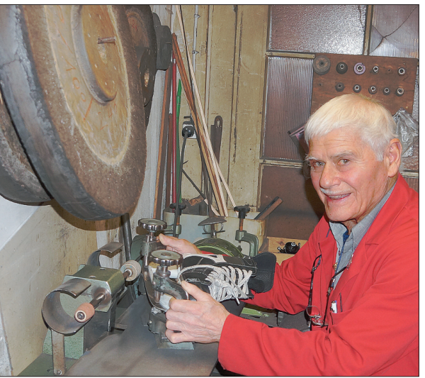
Messerschmied Romano Chiecchi ist ein versierter Schlittschuh-Eisen-Schleifer. Rechts wird das in der Halterung festgeschraubte Eisen an die Schleifscheibe geführt, was grosses Fingerspitzengefühl erfordert.
