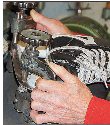
Messerschmied Romano Chiecchi ist ein versierter Schlittschuh-Eisen-Schleifer. Rechts wird das in der Halterung festgeschraubte Eisen an die Schleifscheibe geführt, was grosses Fingerspitzengefühl erfordert.
