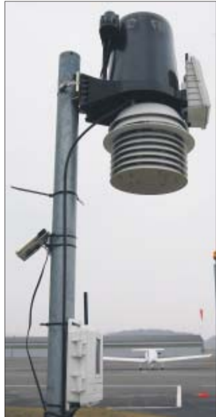
Guido Pelliccioli kontrolliert den elektronischen Regenmesser: Er wird mit Solarzellen betrieben, benötigt jedoch Stützbatterien. Die Daten werden per Funk übermittelt. Rechts die Station, der keine Regung in der Wetterküche entgeht.
