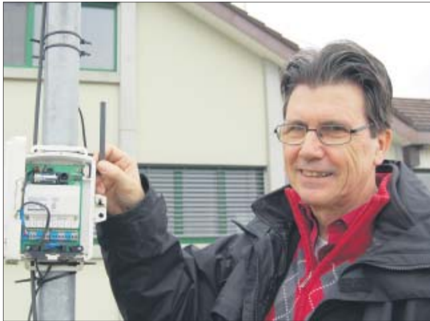
Guido Pelliccioli kontrolliert den elektronischen Regenmesser: Er wird mit Solarzellen betrieben, benötigt jedoch Stützbatterien. Die Daten werden per Funk übermittelt. Rechts die Station, der keine Regung in der Wetterküche entgeht.
