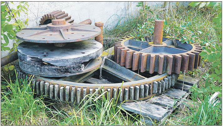
Hannes Keller (l.) und Bernhard Leikauf vor dem Museum mit einer alten Aufnahme aus dem Mühlebezirk. Unten altes Zubehör: Vor der ehemaligen Öle liegt noch einiges Antriebsmaterial herum. Interessant der Holzzahnkranz auf dem grossen Rad. Dieser griff in Eisenzahnkränze und konnte bei gröberen Vorkommnissen als «Sollbruchstelle» dienen. Zudem war es billiger, die abgenutzten Holzzähne zu ersetzen als einen Eisenzahnkranz.
