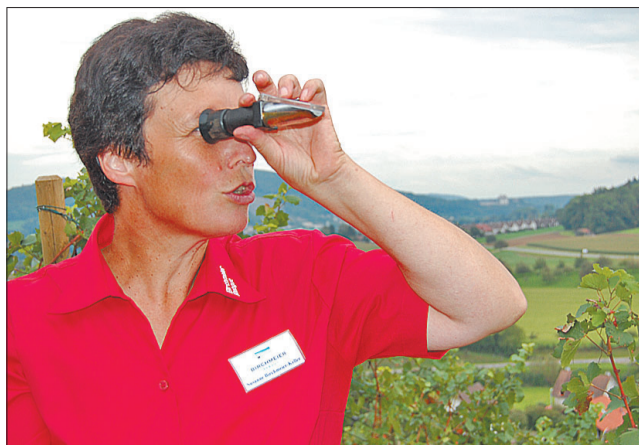
Susanne Birchmeier misst regelmässig die Oechsle-Grade mit dem Refraktometer.
