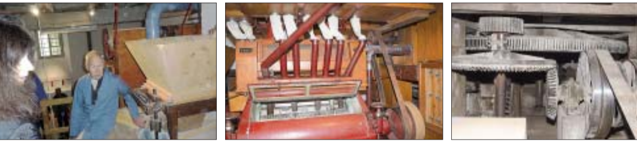
Mitrenovator Urs Obrist erklärte anschaulich, wie so eine Mühle tatsächlich funktioniert. Die 70 Jahre alte Walzenmühle sieht aus wie neu. Rechts das vom Wasserrad angetriebene Zahnräderwerk, das seinerseits die Mühle antreibt.
