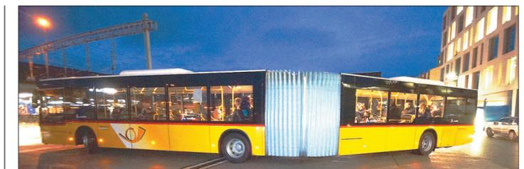
Einer der drei neuen, beladen rund 28 Tonnen wiegenden, knapp 19 Meter langen Gelenkbusse beim Wegfahren vom neuen Busterminal Richtung Birr. Die drei mit modernsten Kommunikationsmitteln ausgestatteten Postautos (Stückpreis rund Fr. 450'000.–) wurden auf die Namen «Aargau», «Brugg» und «Windisch» getauft. Sie haben 54 Sitz- und etwa 78 Stehplätze sowie zwei Rollstuhl-, beziehungsweise drei Kinderwagenplätze.
