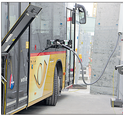
Bezeichnend für den Pioniergeist: erste Wasserstoff-Tankstelle für V-M-Postautos beim Busdepot im Brugger Wildschachen.
