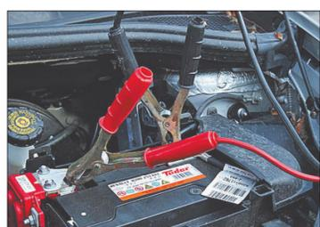
Das kleine Einmaleins der Starthilfe: Zuerst das rote Kabel an die Batterie-Pluspole von Spender- und Empfängerauto anschliessen, dann kommt das schwarze Kabel an den Minuspol des Spenderautos. Als Nächstes das Geber-
