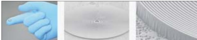
Zonenplatte aus Diamant zur Nano-Fokussierung intensiver Strahlung aus einem Röntgenlaser. Der Durchmesser der gesamten Zonenplatte beträgt 0,5 Millimeter – gerade gross genug um den Laserstrahl aufzusammeln. Die äussersten Ringe sind nur 100 Nanometer dick (und werden zum Mittelpunkt hin dicker)
