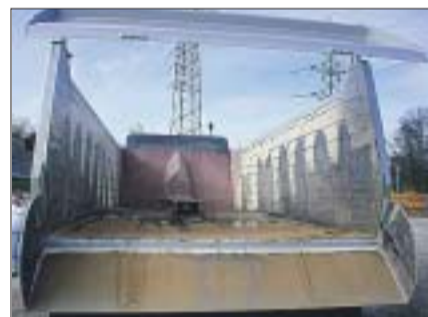
Das Abschiebeaggregat wird horizontal in der Mulde bewegt.
