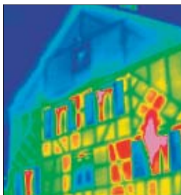
Wärmebild eines Hauses, das die «Lecks», respektive Kältebrücken zeigt. Rechts der Minergie-Auskunftsstand vom letzten Jahr in Luzern.
