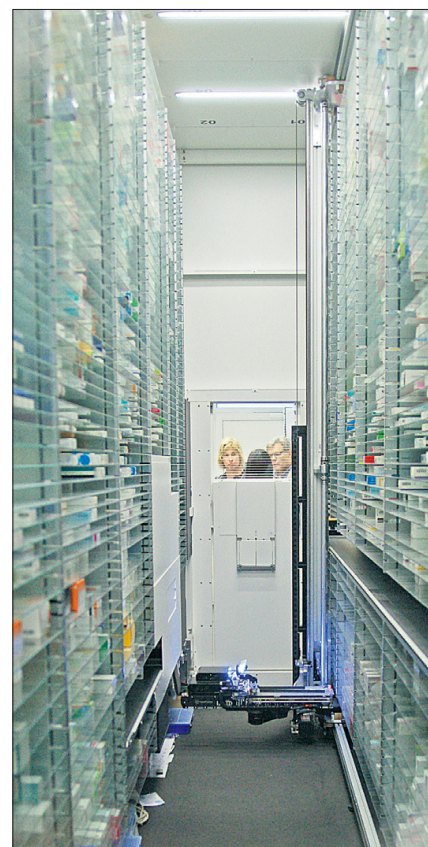
Von Martina Hunziker (r.) süss veranschaulicht: die Funktionsweise des Medi-Automaten (Bild rechts). Dieser liefert, auch Verfalldatum und Temperatur managend, nach der Compi-Bestellung das Gewünschte per Quasi-Rohrpost an den Schalter.
