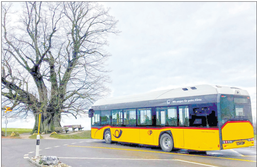
Das neue Wasserstoff-Postauto bei der Linner Linde: Die Brennstoffzellen sind im Heck des Postautos installiert, auf dem Dach befinden sich die Wasserstofftanks.
