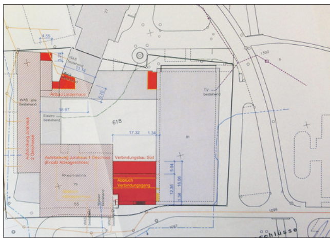
Der Perimeter-Plan links zeigt, was neu gebaut wird – und macht auch deutlich, dass die engen Grenzen der Parzelle heute Parking-Probleme verursachen. Rechts der aktuelle Zustand des Hauptgebäudes (Jurahaus), das aufgestockt werden soll (siehe Pfeil).
