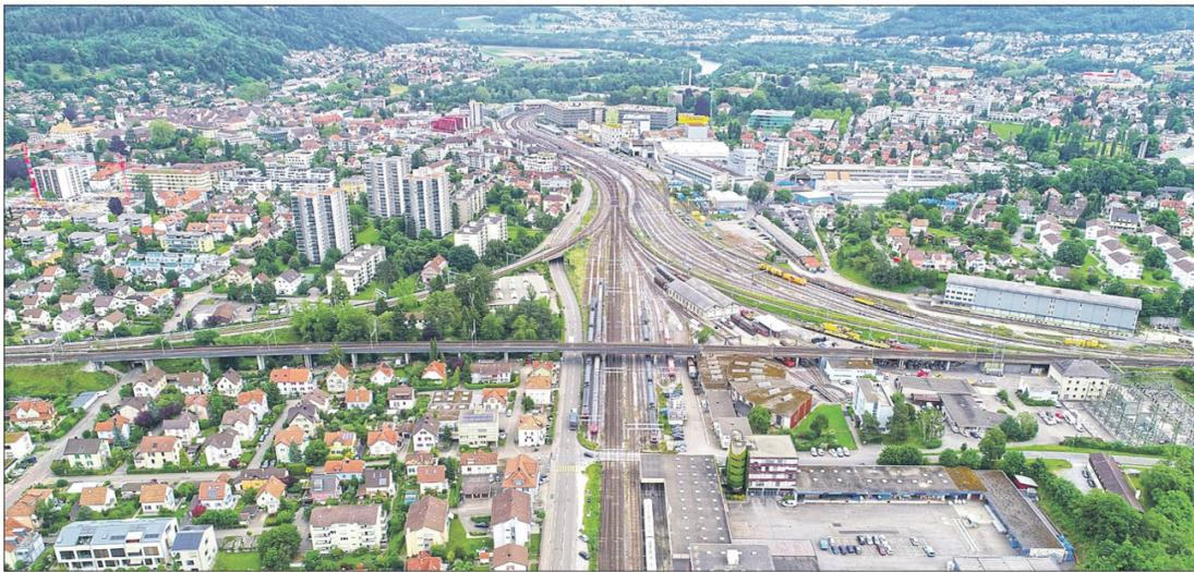
Das unter dem Titel «Substanzerhalt Verbindungsline Brugg» laufende Vorhaben umfasst auch die Erneuerung der beiden Gleise: Rund vier Kilometer Schiene, 3300 Schwellen und 16'000 Tonnen Schotter werden ersetzt – und dabei lärmdämpfende Unterschottermatten eingebaut.
