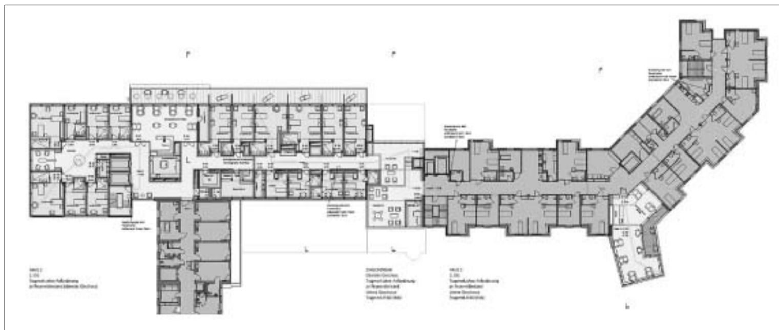
Der Plan zeigt links das auszubauende OG 2 im Haus zwei, in der Mitte das oberste Geschoss des Zwischenbaus und rechts den (hell getönten) Neubau am Haus 3.
