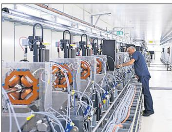
Führungen in der Testanlage: Blick in den Tunnel des 250-MeV-Injektors – hier werden Technologien für den ersten Teil des SwissFEL-Beschleunigers getestet. (Paul Scherrer Institut/Frank Reiser)
