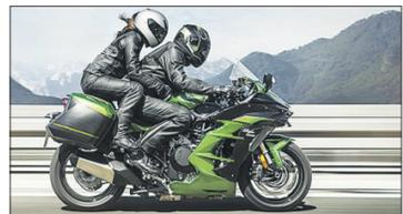
Die neue Kawasaki Ninja H2 SX verfügt über einen flüssigkeitsgekühlten Reihen-Viertakt-4-Zylindermotor mit Kompressor, der 200 PS leistet (bei 256 kg Leergewicht!). Der leistungsfähigste Serien-Sporttourer aller Zeiten ist die ultimative Lösung für Pässe, Autobahnen und Landstrassen. Ab Fr. 21'500.- kann man Pilot dieses technisch ausgereiften Motorrads werden.
