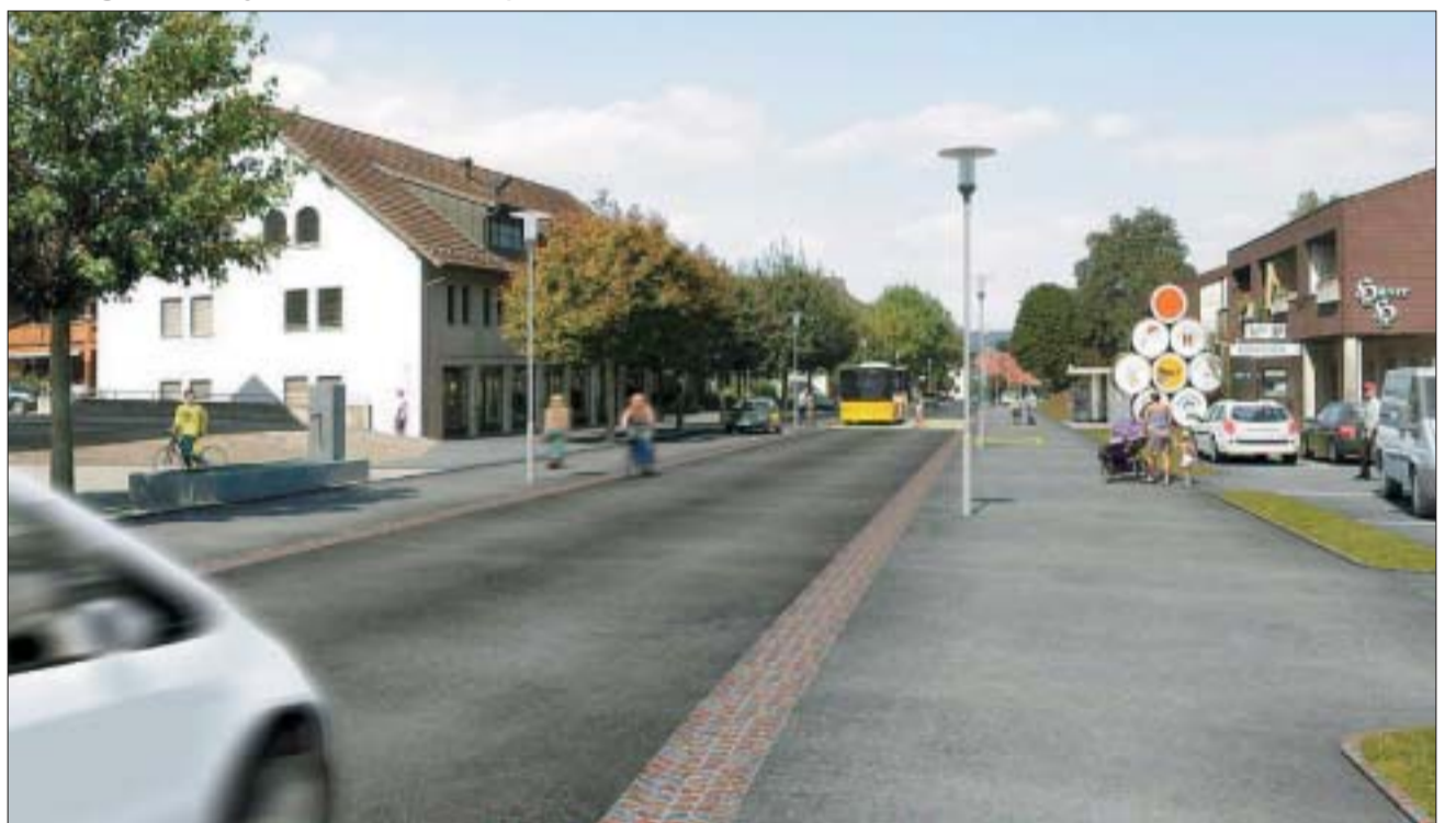
Die Hauptstrasse von morgen soll auf einer Länge von 200 Metern eine Tempo-30 Zone beeinhaltten, welche durch Pforten markiert ist, die das Kreuzen für Autos verhindert. Entlang der Hauptstrasse sollen Fahrbahn und Radweg auf beiden Strassenseiten durch eine 50 Zentimeter breite gepflasterte Fläche getrennt werden. Die beiden im Konzept enthaltenen Fahrbahnhaltstellen in der Dorfmitte (Tempo-30-Zone) sollen für zusätzliche Verkehrsberuhigung sorgen. (Illustrationen Metron AG, Brugg)
