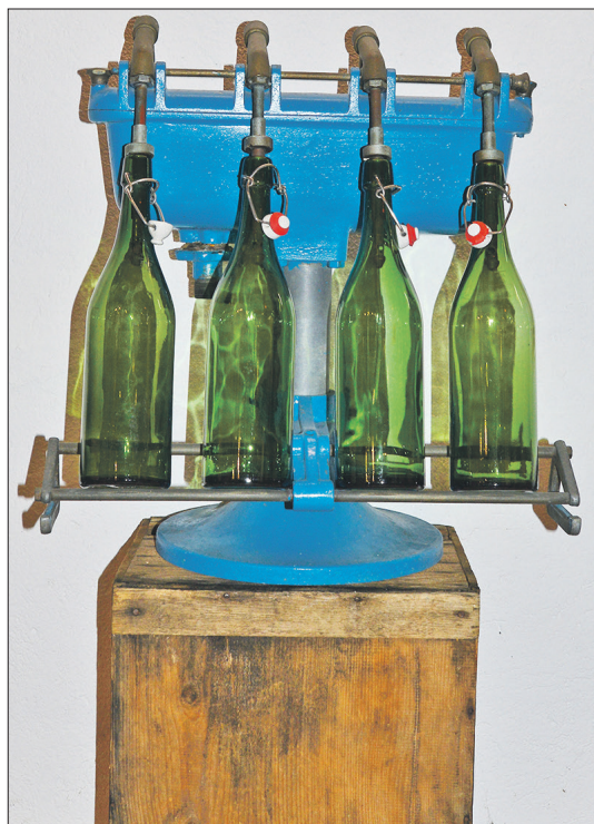
Vierstelliger Flaschenfüller für 1l-Bügelverschlussflaschen. Rechts eine Handpumpe zum Umpumpen des Traubensafts. Auf den Regalen im Hintergrund Fotos und alte Flaschen mit Etiketten.
