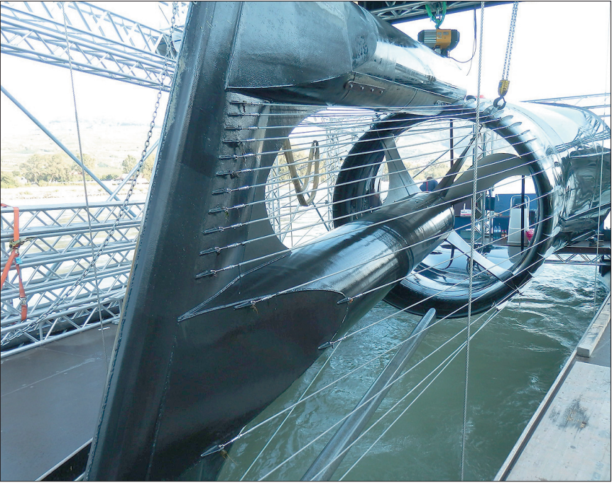
Links die Standorte der Strömungsturbinen in der Aare aus der Vogelschau. Rechts: Die Stromboje schützt durch die erprobte Stahlseil-Bespannung die Fische davor, in die Turbine zu geraten.
