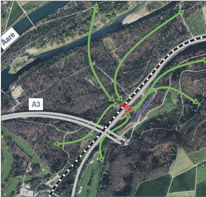
Die Wildtierunterführung führt unter der Aarauerstrasse und der parallel dazu verlaufenden SBB-Strecke hindurch (im Lageplan rot). Ob die Wildtiere die neuen Möglichkeiten (grüne Pfeile) dann in Anspruch nehmen, wird gemessen: «Die Erfolgskontrolle findet mittels Tier-Fotofallen statt», betont Projektleiter Martin Strübi.
