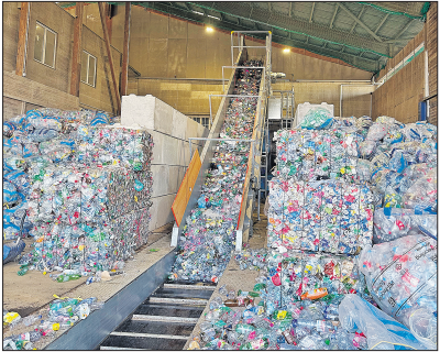
Gewichtige Investition: das raumgreifende Förderband der Kanalballenpresse in Aktion.
