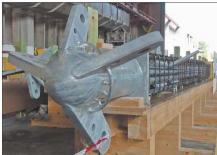
Für die Aussenanlage des neuen Affenhauses im Basler Zoo (Inbetriebnahme 2012) fertigt die Element AG 39 solche 12 Tonnen schwere Zaunpfosten aus mit Beton ummantelten Stahl. Unten das Farbmusterlager. Da kann man sich alle möglichen Farben und Strukturen aussuchen. Daneben die Vorfertigung einer so genannten Rippenplatte für die Kantonsschule Heerbrugg. 312 dieser 7, 87 Tonnen schweren Elemente werden geliefert.
